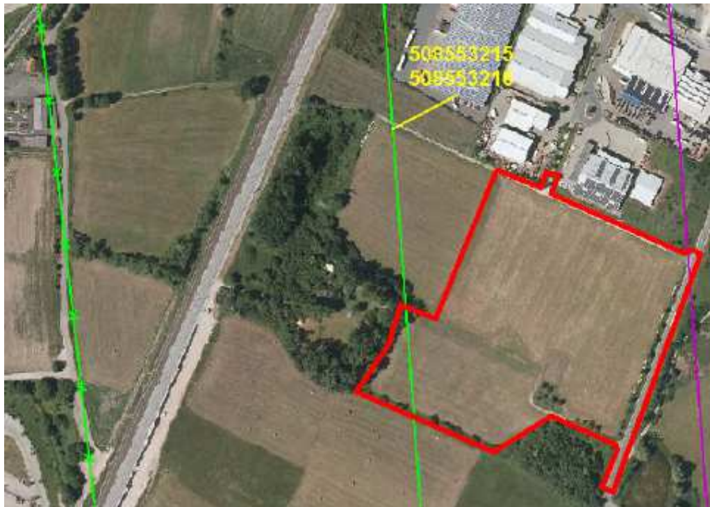
Abb. 10: Darstellung der das Plangebiet (rot umrandet) kreuzenden Richtfunktrassen (grüne und violette Linien, Darstellung genordet, o. M., Quelle: Telefonica Germany GmbH & Co. OHG)
